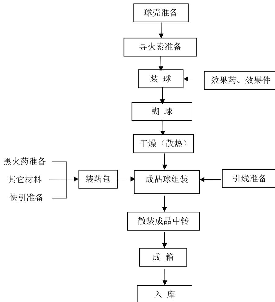
图 2.3-5 喷花类产品生产工艺流程图
