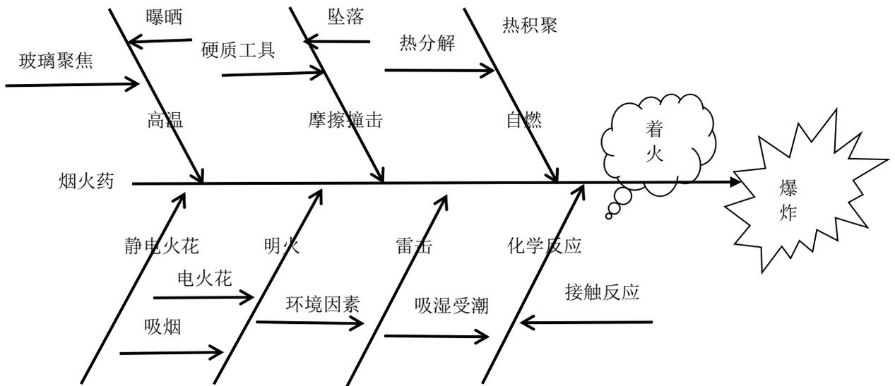
图 3.9-2 烟火药燃烧、爆炸触发条件分析图
