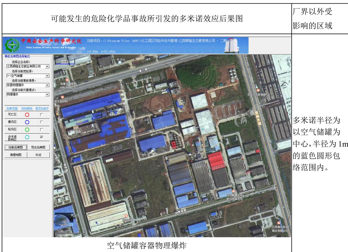
根据多米诺分析可知，该项目产生多米诺半径最大的为空气储罐容器物理爆炸，空气储罐在安全附件失效、制造和安装质量缺陷等，储罐可能发生容器物理爆炸，多米诺半径为以空气储罐为中心，半径为 1m 的蓝色圆形包络范围内。企业应加强压力容器的安全管理。
